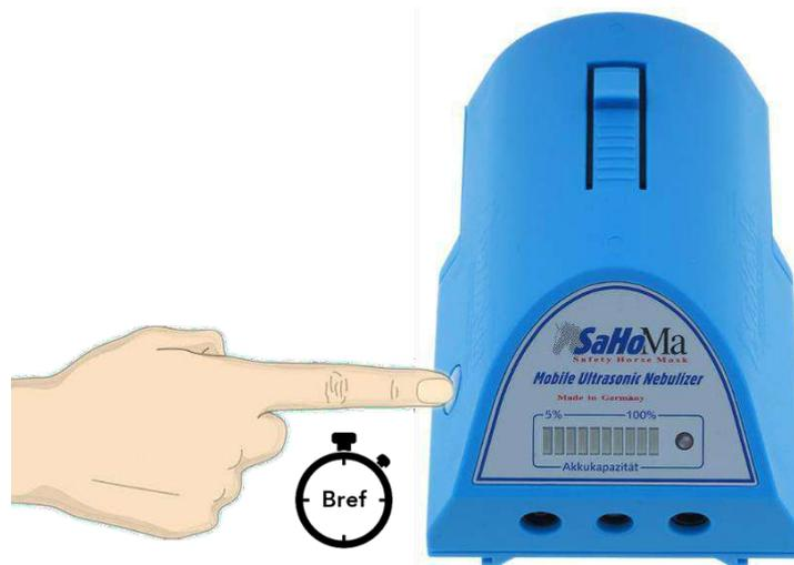
Les barres lumineuses montent d'abord à 100 % puis retombent à la capacité réelle de la batterie. Une barre lumineuse correspond à une capacité de batterie de 10 %.
