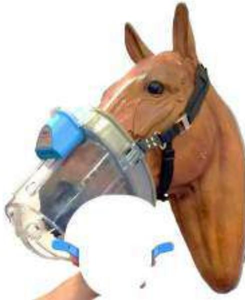
Faites glisser le panier-filtre du SaHoMa®-II avec la membrane filtrante SaHoMa®-II insérée vers l'avant sur les deux goupilles de fixation latérales du boîtier du SaHoMa®-II. Ensuite, pressez les deux sangles du panier à filtre SaHoMa®-II sur les goupilles de fixation jusqu'à ce qu'elles s'enclenchent de manière audible.
